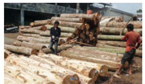
Albizia f., écorçage et conditionnement billes de déroulage, scierie ind. Temanggung, île de Java centrale
